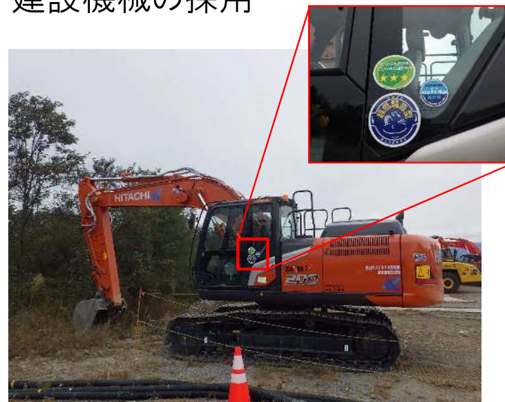
排出ガス対策型、低騒音型 建設機械の採用
