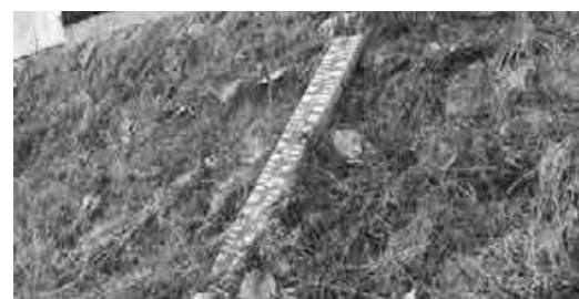
壬生沢川の量水標・水位を測る標識
