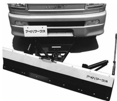
軽トラに取付可能な除雪機
